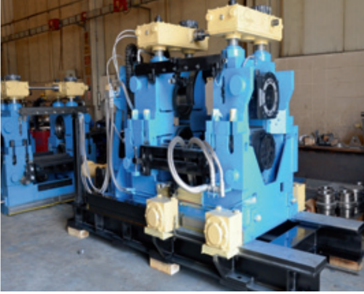
HADDE TEZGAHI ÖN GERİLMELİ HAZIRLAMA GRUBU (Max. 660 - Min.550 mm) (Roll Stands Housingless Type)
