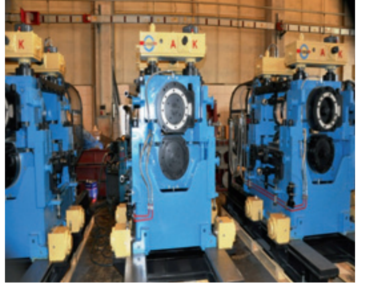
HADDE TEZGAHI ÖN GERİLMELİ ARA GRUP (Max 380 - Min.310 mm) (Roll Stands Housingless Type)
